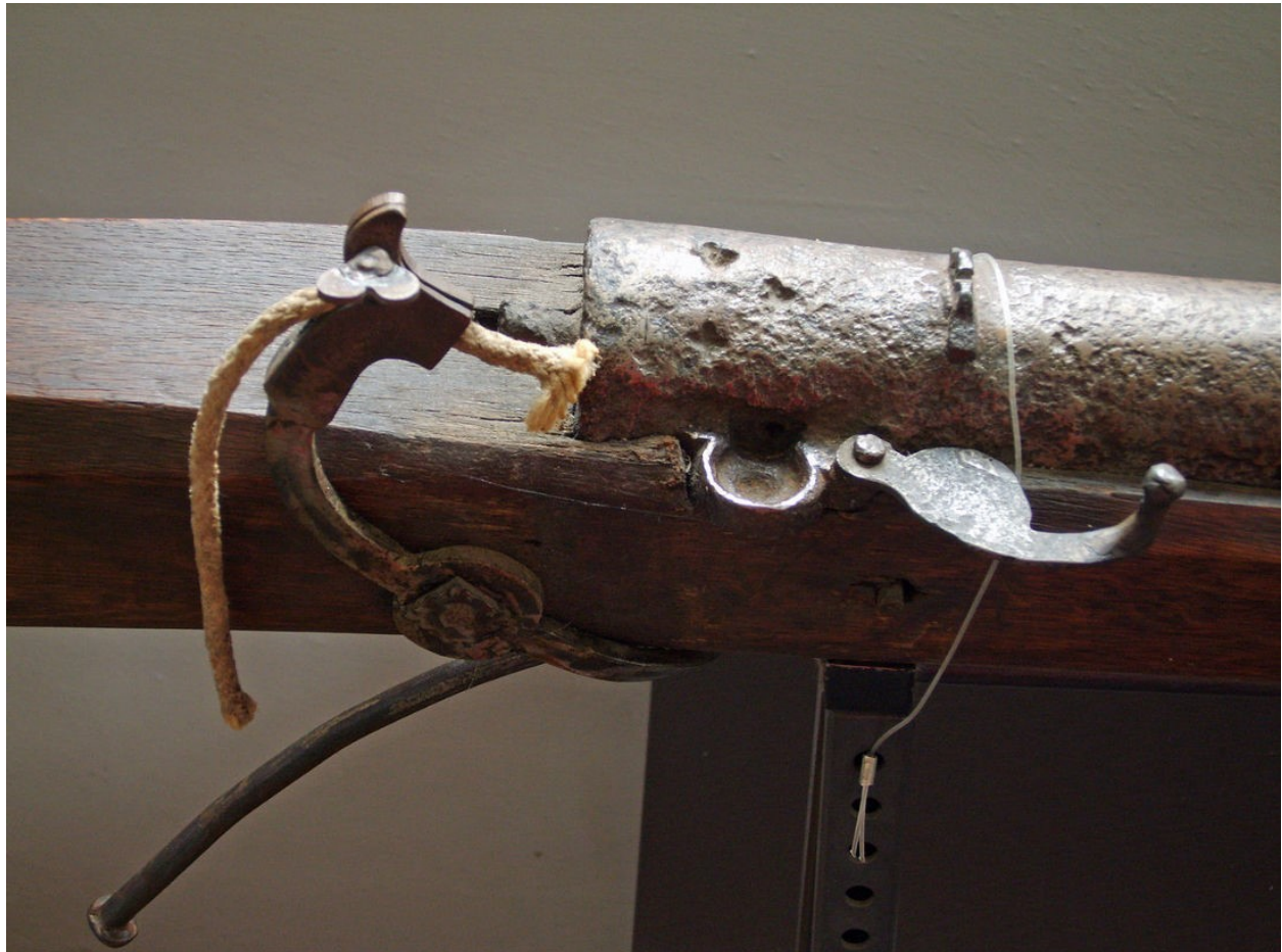
Fig. 3. Lontslot van een Duitse haakbus. De haan is direct gekoppeld aan de hendel en beweegt de lont in de kruitpan (wikipedia). De kruitpan is voor de veiligheid afsluitbaar.
